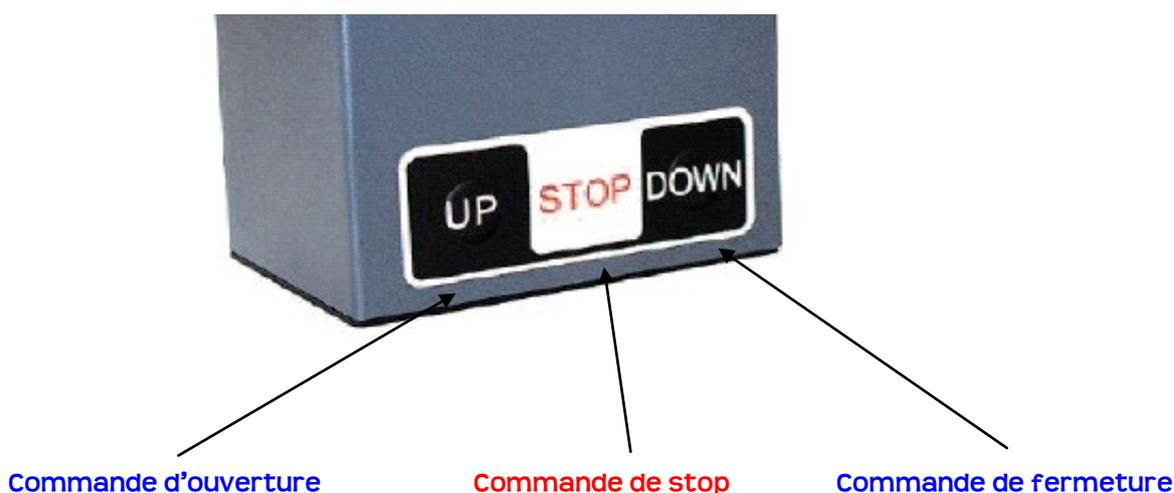
**La présence du clavier de couvercle sur le connecteur ( dans le bon sens ) est indispensable au fonctionnement de l'armoire**
