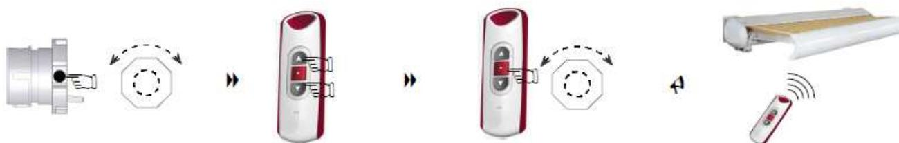
Appuyer sur le bouton rouge de la tête moteur , un bref mouvement dans chaque sens indique que le moteur entre en phase de programmation
