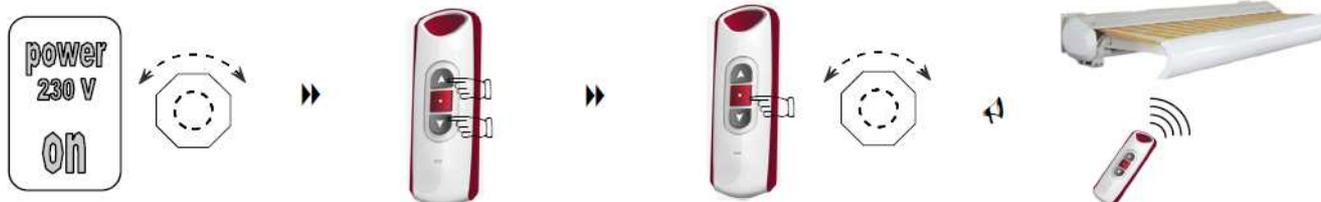
A la mise sous tension , un bref mouvement dans chaque sens indique que le moteur entre en phase de programmation
