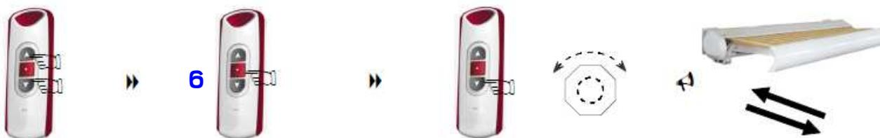
Appuyer simultanément sur « monte » et « descente » puis **6 fois** sur « stop » et enfin sur « descente », le moteur fait un bref mouvement dans chaque sens , le sens de montée et descente est inversé.
