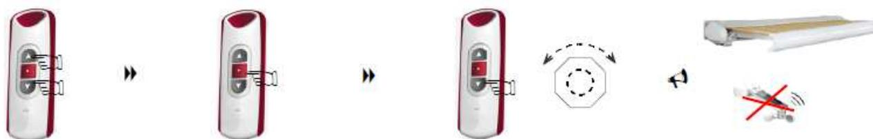
Appuyer simultanément sur « monte » et « descente » puis sur « stop » et enfin sur « descente » ,le moteur fait un bref mouvement dans chaque sens alors le capteur WSR5001 est désactivé .
