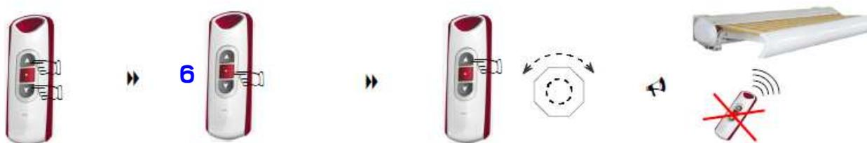
Pour effacer la programmation d'un ou des émetteurs, il faut : Appuyer simultanément sur « monte » et « descente » puis **6 fois** sur « stop » et enfin sur « monte », le moteur fait un bref mouvement dans chaque sens , il n'est plus possible de commander le moteur sans faire une nouvelle programmation d'émetteur.
