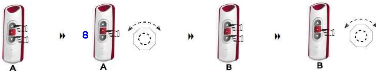
Pour copier le code d'un émetteur déjà programmé , il faut : Appuyer simultanément sur « monte » et « descente » puis **8 fois** sur « stop » sur l'émetteur **A** déjà programmé , le moteur fait un bref mouvement dans chaque sens
