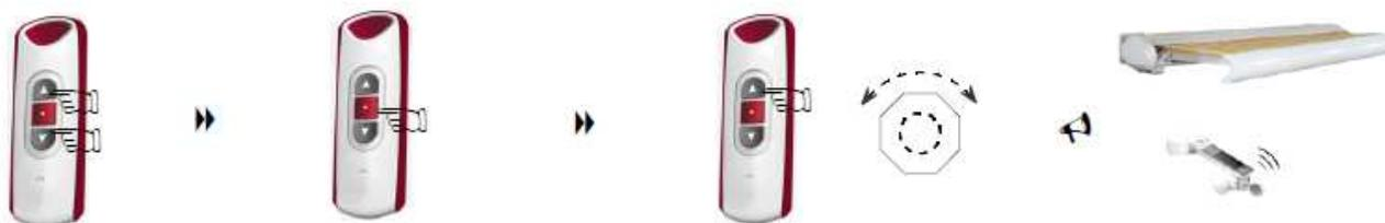
Appuyer simultanément sur « monte » et « descente » puis sur « stop » et enfin sur « monte », le moteur fait un bref mouvement dans chaque sens alors le capteur WSR5001 est activé .
