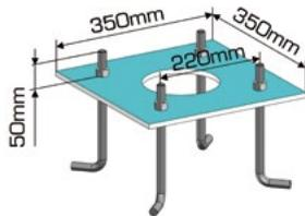
Le gabarit reste en place de niveau et doit reposer entièrement sur massif béton.
